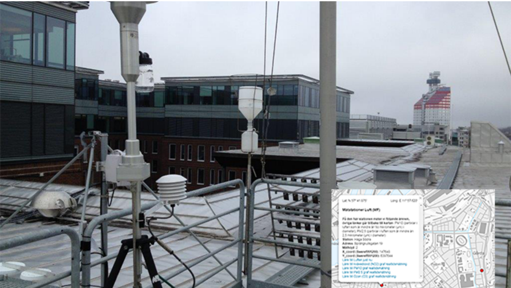
Mätstationen för luft på Nordstans tak och ett urklipp från luftkartan. Foto: Miljöförvaltningen, Göteborgs Stad
